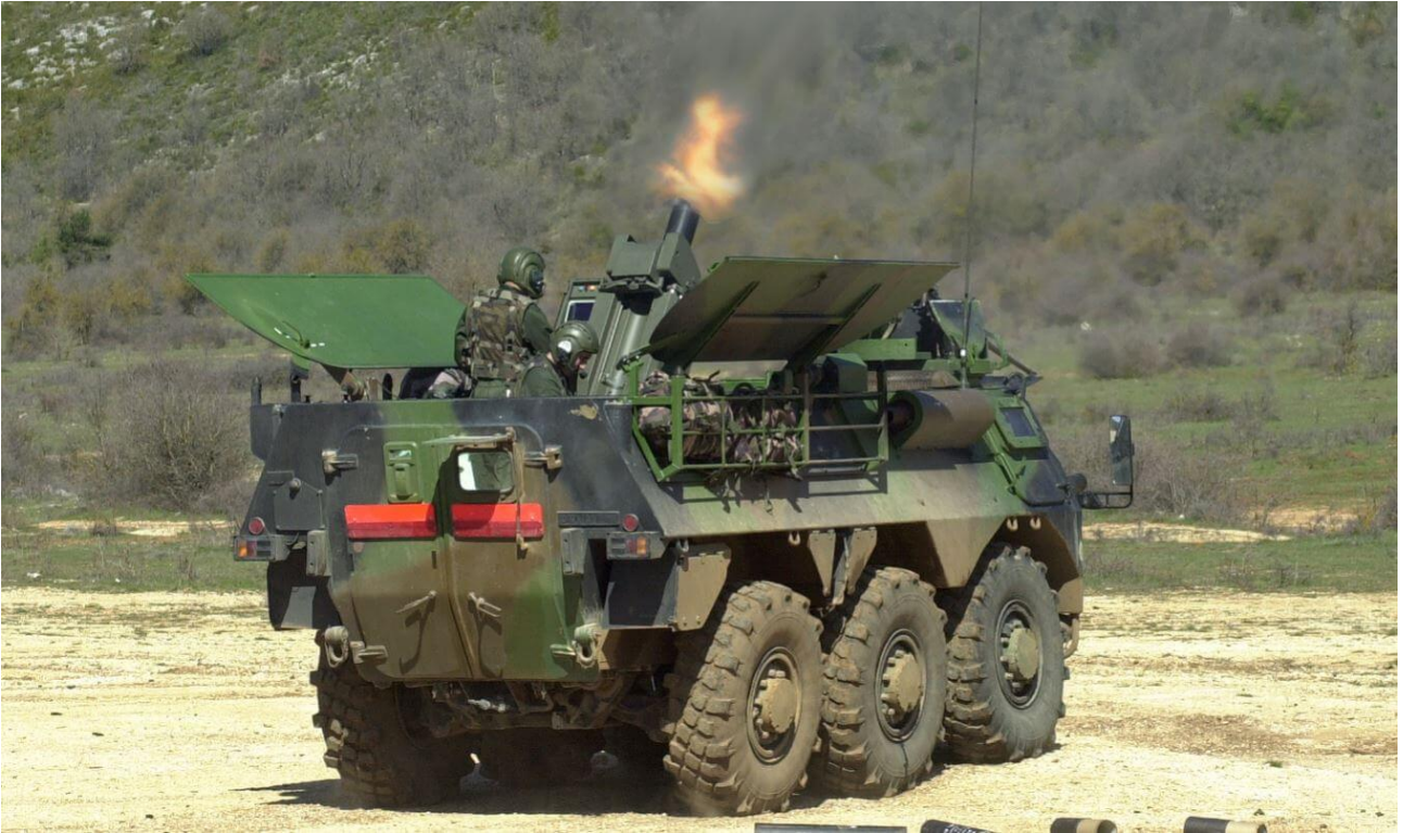
Mortier rayé embarqué de 120 mm dans un VAB 6X6. Le Griffon étant plus volumineux que le VAB, il pourrait emporter encore plus de munitions.
