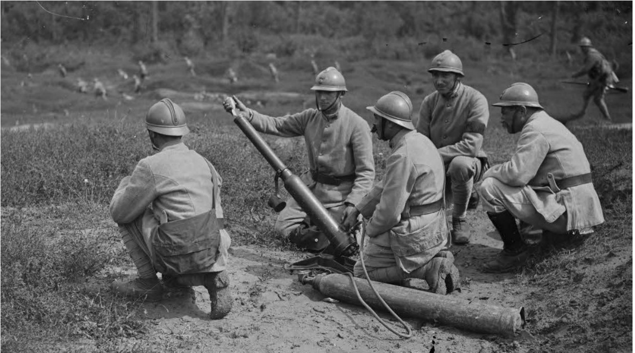
Obusier pneumatique de tranchée Brandt 60 mm, modèle 1916.
