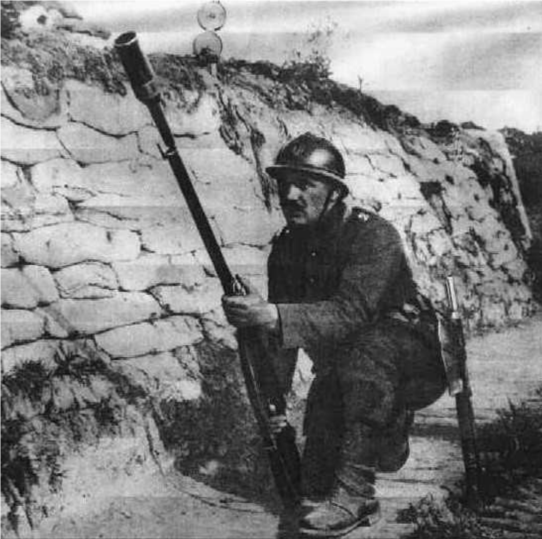
Tromblon VB (Viven Bessière). Permet le tir d'une grenade de 450 grammes jusqu'à 200 m.
