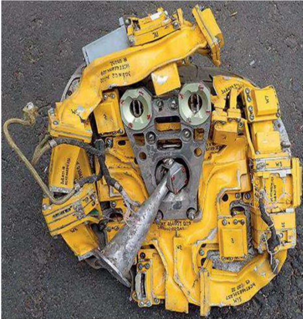
Autodirecteur radar 9B918 fonctionnant entre 8,15 Ghz et 10 Ghz.
