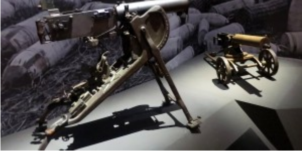
Au 1er plan, une mitrailleuse MG 08 allemand (cal 7,92 - 500 coups / min) En arrière plan, une mitrailleuse Maxim PM 1910 russe (cal 7,62 - 600 coups / min)
