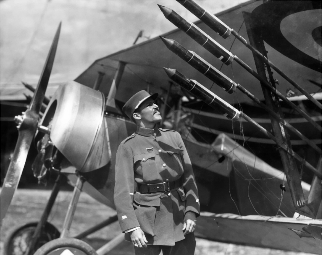
Le pilote américain Norman Prince (escadrille La Fayette) examinant des fusées Le Prieur.
