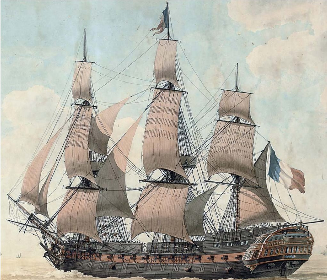
Le Mont-Blanc, vaisseau de 74 canons de la classe Téméraire, construit d'après les plans de Sané à Rochefort (sous le nom de Pyrrhus).
