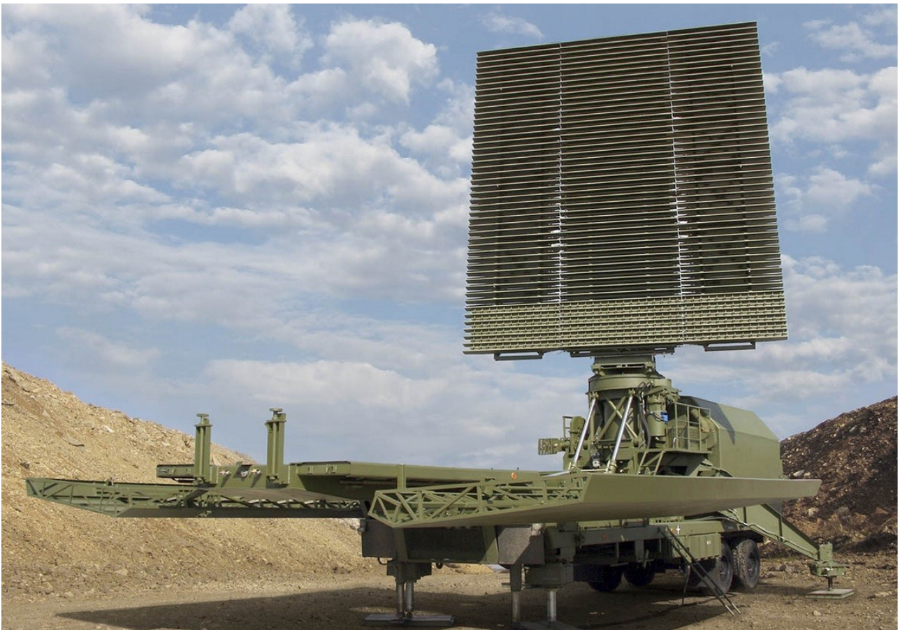
Radar tridimensionnel développé pour la détection et la poursuite de toutes cibles aéroportées,
