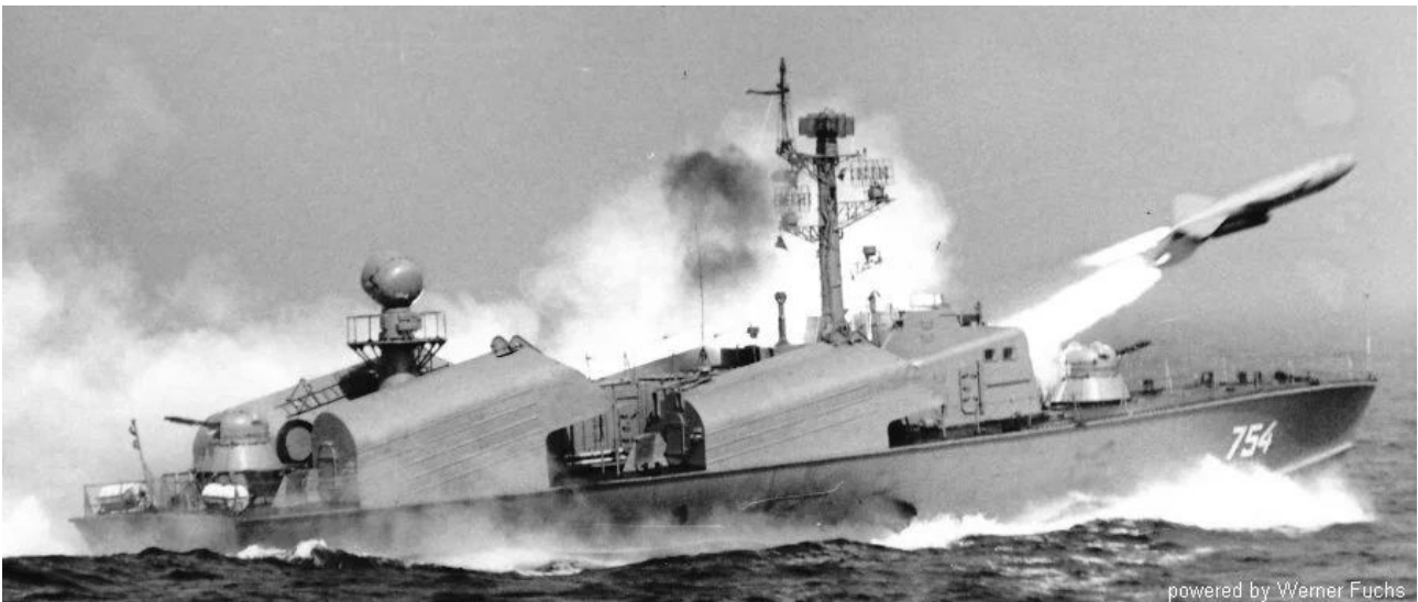
Patrouilleur est-allemand OSA tirant un missile P-15 : la puissance de feu d'un navire de premier rang pour 200 tonnes de déplacement.
