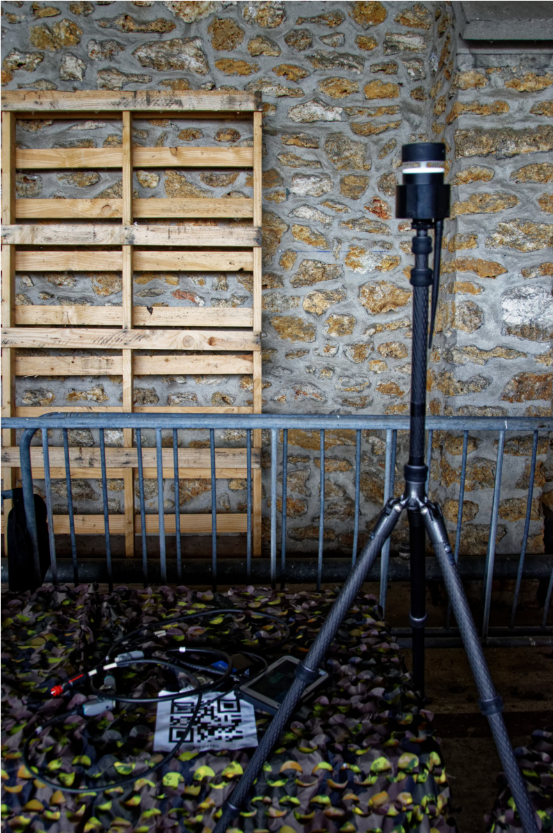
Le système de kit météo déporté portatif, lors de la journée de Présentation des Capacités de l'armée de Terre (PCAT), est fixé sur un trépied léger en carbone (2,5 kg), facilement transportable dans une gaine. Crédits : FSV / MA.
