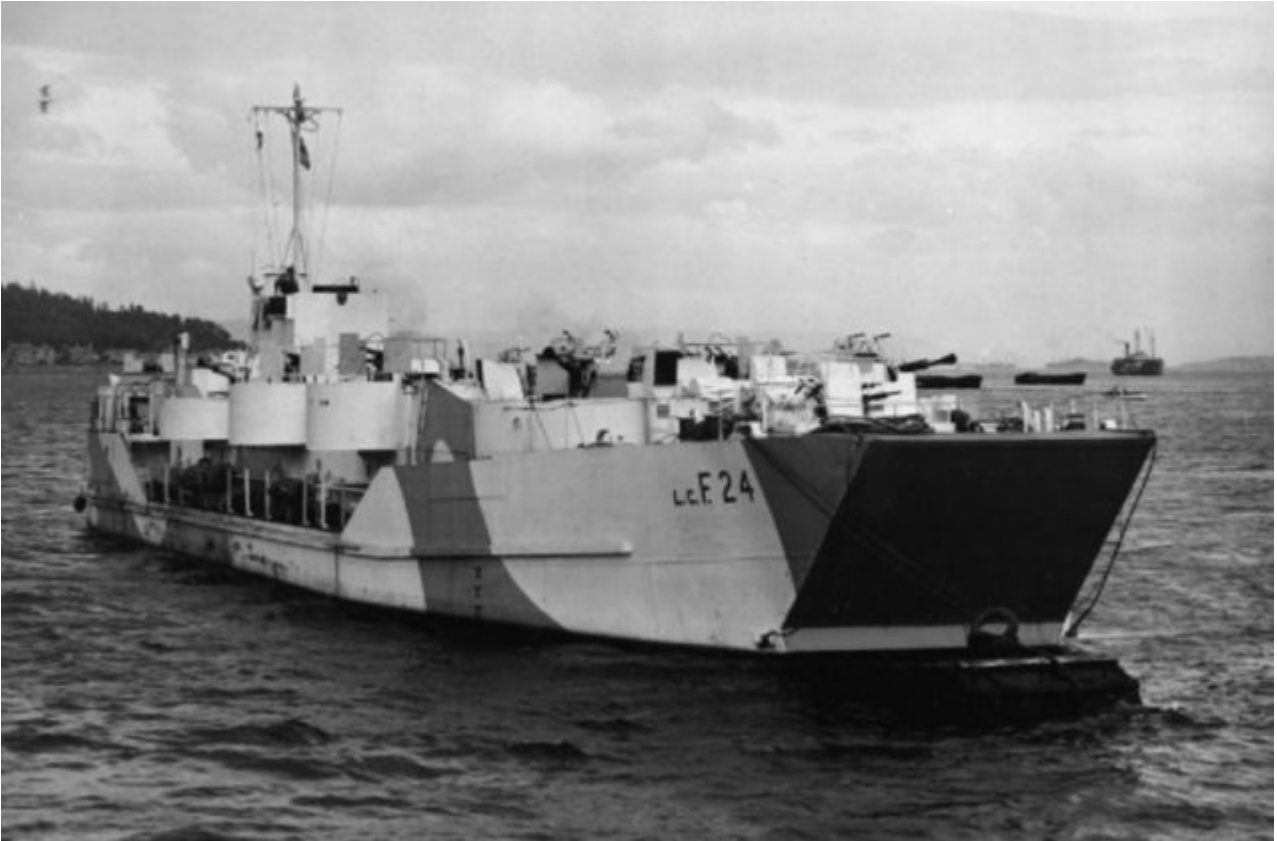
LcF armé de canons anti-aérien de 20 mm Oerlikon et de 2 canons QF de 40 mm. Crédit : DR.
