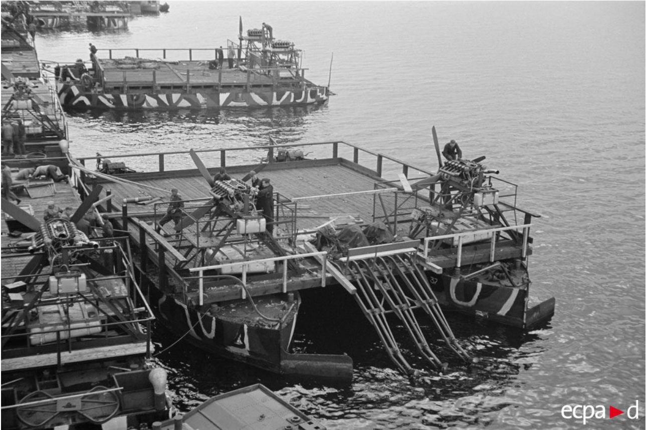
Fährprahm allemands accostés dans le port d'Ostende, un groupe de barges équipées d'un système de propulsion mixte (moteurs d'avions et de navires). Crédit : ECPAD.
