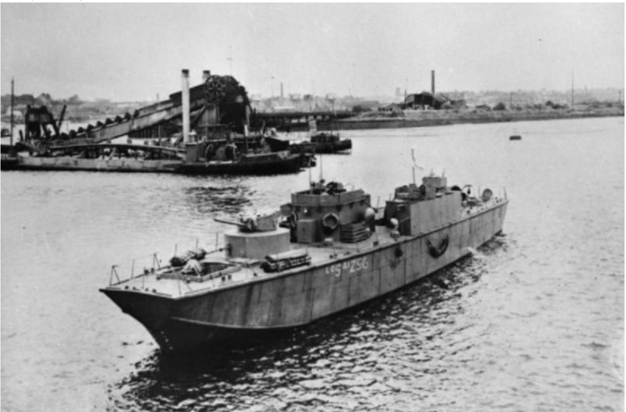
LCS (Support) armé avec un canon anti-tank en tourelle. Crédit : DR.
