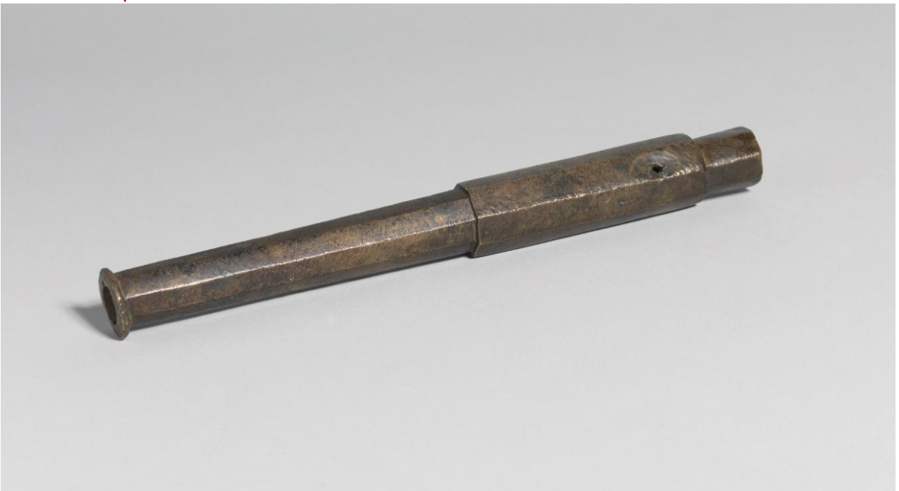
Canon de Loshult. (Longueur : 300 mm ; diamètre : 110 mm, 70 mm à la bouche : poids 9 kg). Source : Wikipedia.
