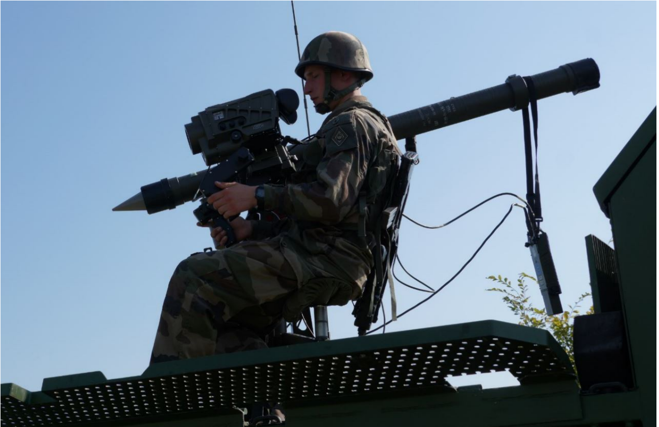
Station de tir Mistral équipée de la nouvelle caméra thermique SANDRA. Crédit : Stéphane Gaudin.
