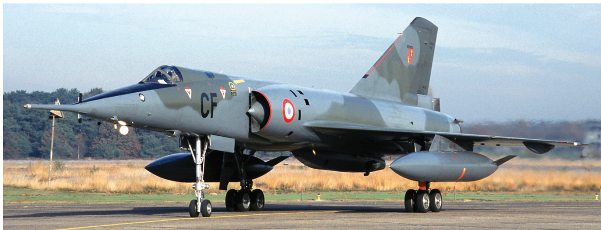
Le Mirage IV P n°59 de l'EB 1/91 Gascogne, équipé d'une nacelle de photo-reconnaissance CT52 et de réservoirs pendulaires de 2500 L. DR
