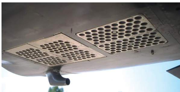
Lance leurres ALKAN F1 pouvant contenir 104 cartouches de leurres EM et 84 cartouches de leurres IR, sous le croupion d'un Mirage IV P. Crédits H. Beaumont.
