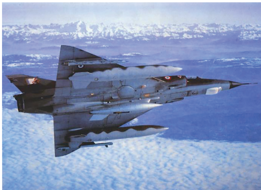
Un Mirage III E de l'EC 2/4 La Fayette en configuration nucléaire tactique, emportant un conteneur d'entraînement nucléaire en point ventral, deux réservoirs de 1 700 l, un lance paillettes Phimat au point 2 sous voilure droit et un détecteur brouilleur Barax au point 2 sous voilure gauche". Crédit photo : DR/Coll. H. Beaumont.
