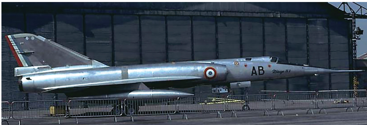
Le Mirage IV A n°3, configuré avec des réservoirs pendulaires de 2500 L.
