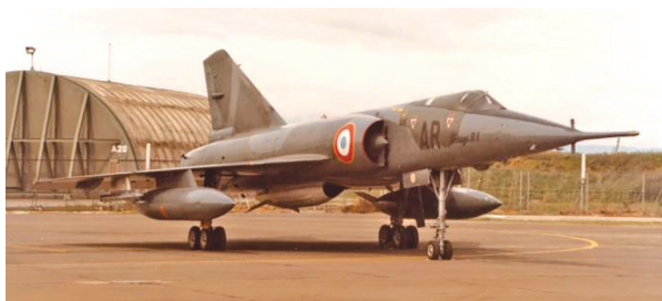
Le Mirage IV A n°19 en configuration nucléaire avec des réservoirs de 2 500 l, une maquette de la bombe AN 21 en point ventral et avec un conteneur lance paillettes Phimat aux points 2 sous voilure. Crédits : DR/Coll. H. Beaumont.
