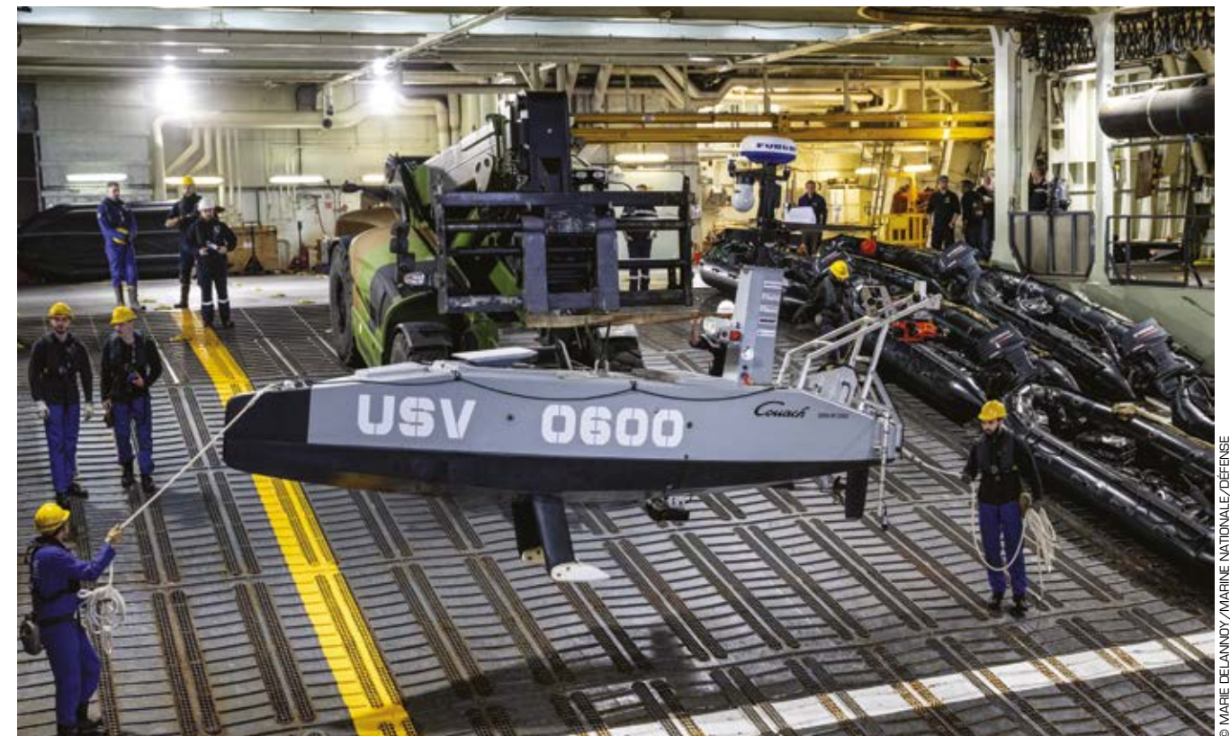
Le drone de surface Couach 0600 , également appelé Magellan, testé en mars dernier par la Marine nationale lors de l'exercice amphibie Dragoon Fury 2025 au large de Toulon. Ce drone destiné à de multiples missions (surveillance, renseignement, guerre électronique...) est le premier réalisé par les Chantiers navals Couach, ETI française d'environ 300 salariés installée à Gujan-Mestras en Gironde.
