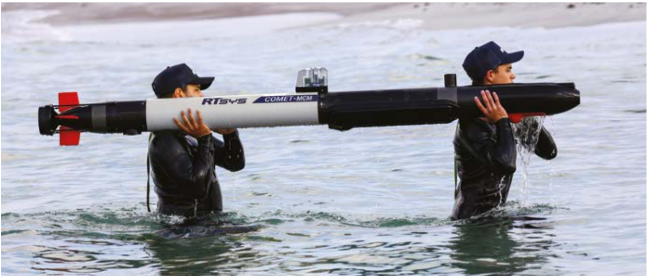
L'AUV COMET-MCM déployé depuis une plage lors d'un exercice OTAN. Ce véhicule autonome, spécialisé dans la lutte antimines, est aussi capable de réaliser des relevés bathymétriques de haute résolution, de la collecte de données environnementales, des inspections acoustiques... Cette plateforme portable et versatile est conçue par RTSys, ETI française d'environ 75 ingénieurs et experts, basée en Bretagne, à Caudan (Morbihan), qui y associe électronique de pointe, algorithmes de détection intelligente et acoustique sous-marine.
